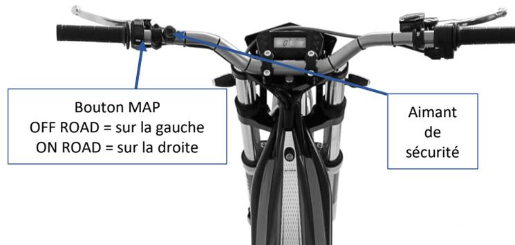
Sur la gauche du guidon, l'aimant de sécurité est présent pour la mise en fonctionnement de la moto.
